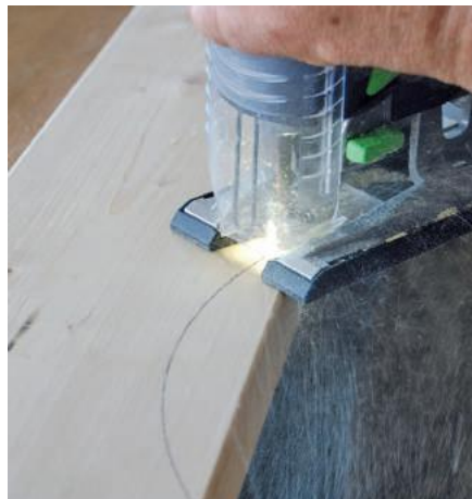
KROK 2. Precyzyjne wycinanie ozdobnych linii prostych i po łuku za pomocą wyrzynarki
