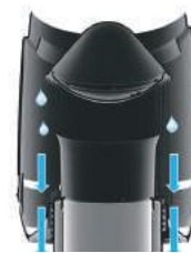
Głowica Flow nowej generacji zapewnia pionowy wyrzut powietrza i odprowadzenie wody deszczowej
