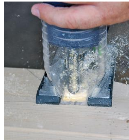
KROK 2. Precyzyjne wycinanie ozdobnych linii prostych i po łuku za pomocą wyrzynarki
