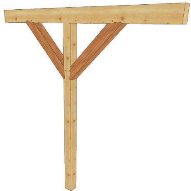
Połączenie miecz-słup na wręb z czopem
