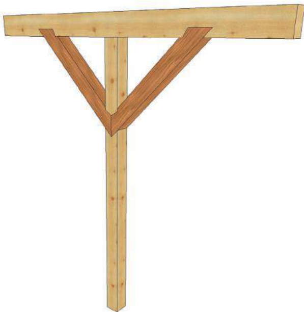
Połączenie miecz-słup na nakładkę z wrębem
