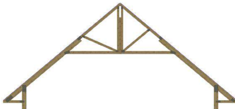
Rys. 3. Wiązary prefabrykowane stosowane do konstrukcji dachów o dużej rozpiętości
