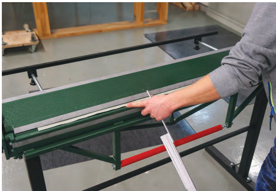
Gięcie elementów blaszanych
