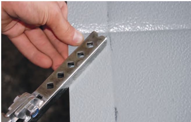
KROK 2. Przetłaczanie, przegięcie blachy po linii trasowania
