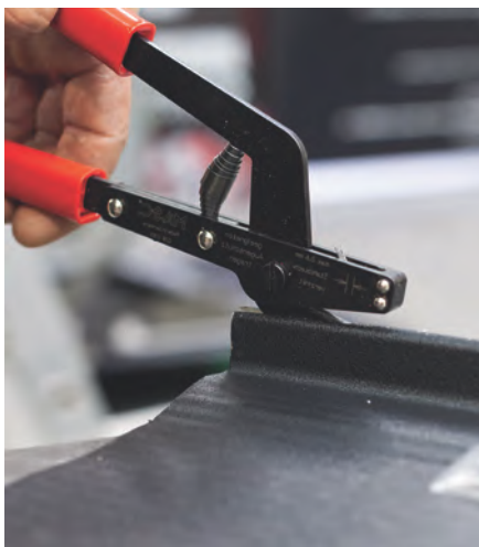
Podcinak – wycięcie zamka w panelu
