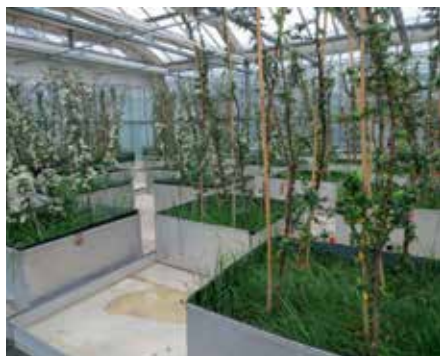
Badanie odporności membrany EPDM Resitrix SKW na przerastanie korzeniami roślin
