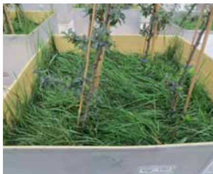
Badanie odporności membrany EPDM Resitrix SKW na przerastanie korzeniami roślin
