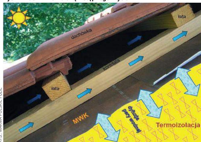
Rys. 1. Dach z membraną wstępnego krycia
