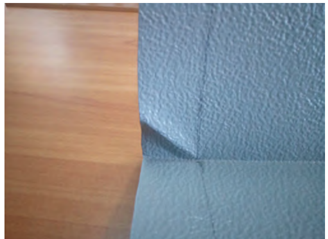
KROK 3. Blacha po przetłoczeniu
