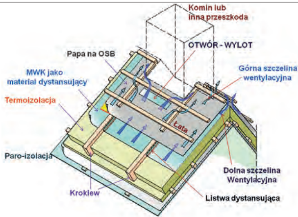
Rys. 4. Schemat pokazyjący jak wypuścić powietrze z dolnej szczeliny wentylacyjnej znajdującej się pod poszyciem, koniecznej w dachach z poddaszem mieszkalnym i pokryciem uszczelnionym papą. Jest to schemat obowiązujący dla wszystkich uszczelnień układanych na płytach OSB i MFP
