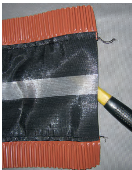
Fot. 2. Taśma kalenicowa z tkaniną wykonaną z polipropylenowych tasiemek nie przepuszcza powietrza o ciśnieniu zbliżonym do atmosferycznego. Blokuje wentylację pokrycia
