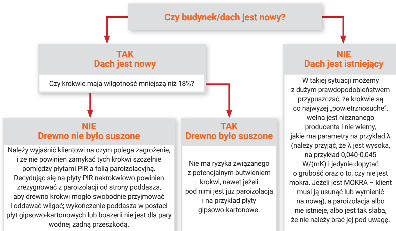
Schemat 1. Uproszczony schemat analizy wilgotnościowej krokwi lub dachu
