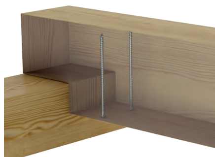
Zabezpieczenie przed pęknięciem belki z wcięciem
